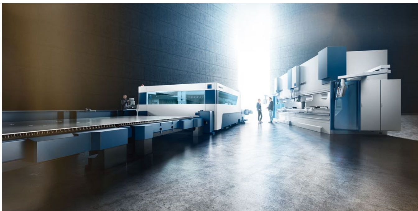
TruLaser 8000 és TruBend 8000: túlméretes formátumú munkadarabok lézervágása és hajlítása.
